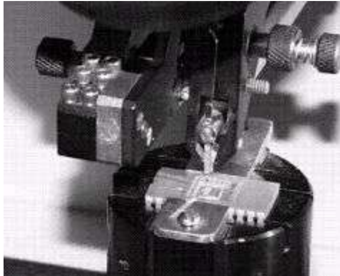
Микрозондирование чипа, извлеченного из смарт-карты
