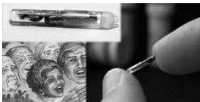
VeriChip , подкожная капсула с микросхемой RFID
